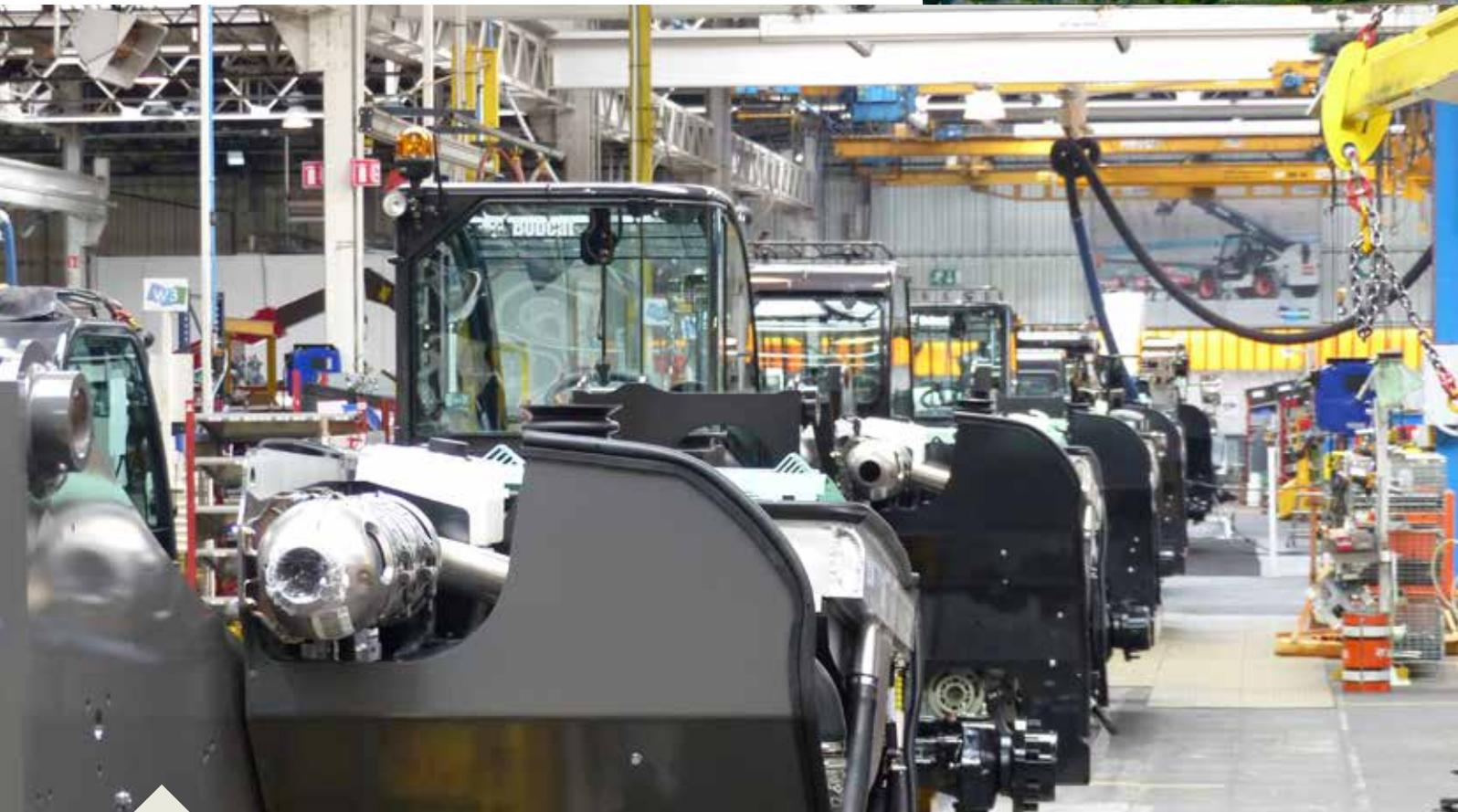
Durch ein hohes Maß an technologischer Integration beim Schweißen von Ausleger und Rahmen, bis hin zur Endmontage der Maschine, werden Produktivität und Qualität durch moderne Produktionsausrüstung, wie Schweißroboter, Strahlanlage, Zweischicht-Lackierkabine sowie eine Weltklasse-Bauteilintegration sichergestellt.
